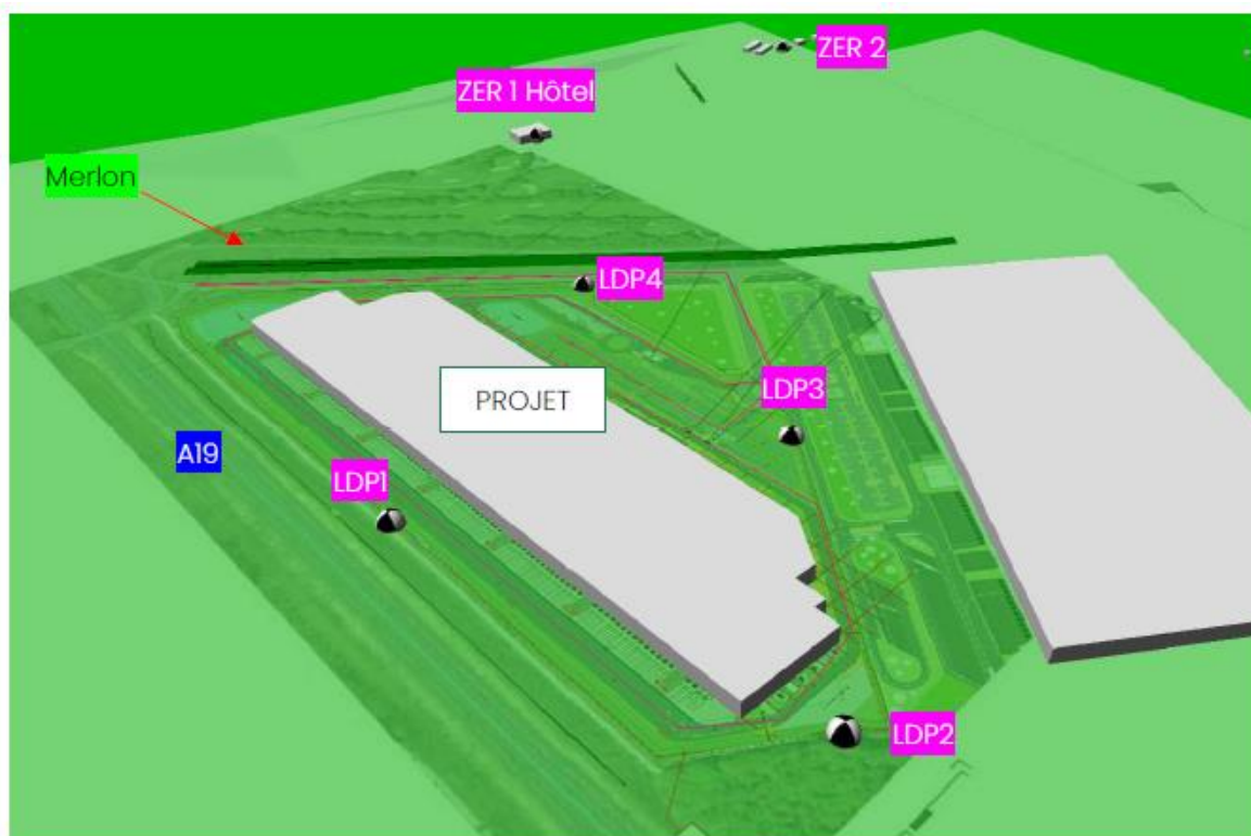
vue 3D de la modélisation Cadnaa avec emplacement des points de calculs
